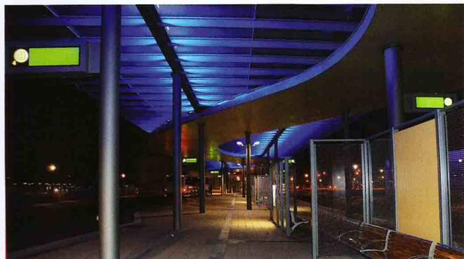
In jedem Glasfeld der Bussteigüberdachung wurden zwei LED-RGB-Lichtbänder montiert, die den Busstiegbereich in der Dunkelheit mit wechselnden Farbtönen anstrahlen.
